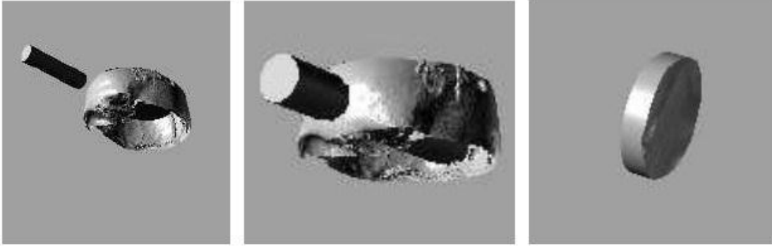
Fig.1 Obținerea suprafeței osoase necesare în cranioplastie prin intersecție booleană între un cilindru (suprafață aleasă demonstrativ) și suprafața craniană
